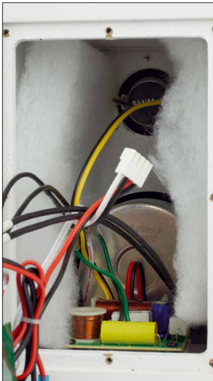
Die passive Frequenzweiche sitzt auf dem Boden hinter dem Tieftöner. Die 12-dB-Filter sind aus sehr ordentlichen Bauteilen aufgebaut
