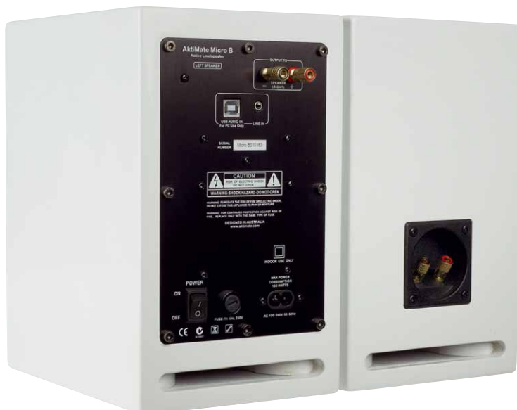
Die gesamte Elektronik ist in der linken Box untergebracht, bei der rechten handelt es sich um eine ganz normale Passivbox
