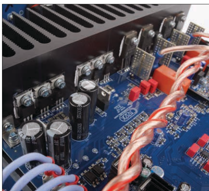
Mit seiner innovativen Schaltung kommen die Endstufen mit einem vergleichsweise kleinen Kühlkörper aus
