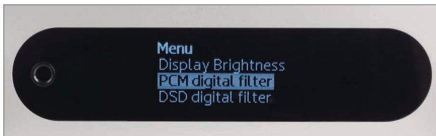
Das OLED-Display ist ausgezeichnet ablesbar und ermöglicht Zugriff auf unterschiedliche Systemoptionen
