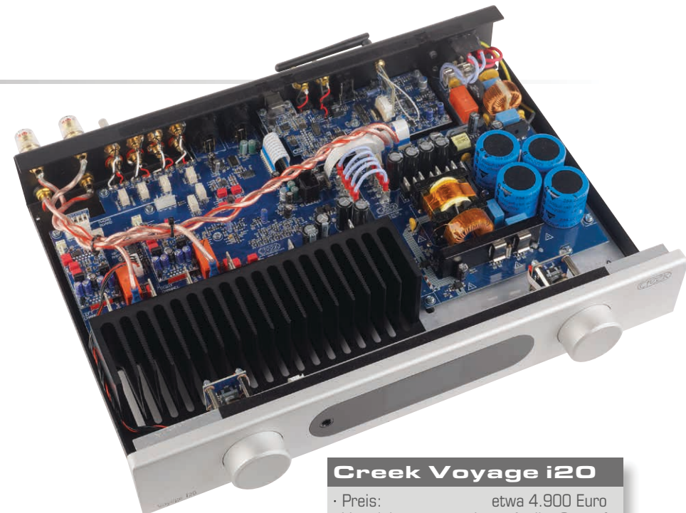
Creek setzt auf möglichst kurze Signalwege und versucht wo es nur geht auf zusätzliche Bauteile zu verzichten
