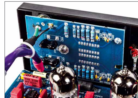
Hinter dieser EIngangsplatine sitzen die DIP-Schalter, mit der die Chinook an das System angepasst werden kann
