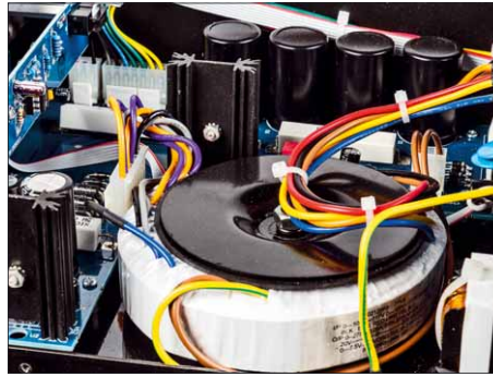
Der Ringkerntrafo in der Netzteilsektion ist mehr als ausreichend dimensioniert
