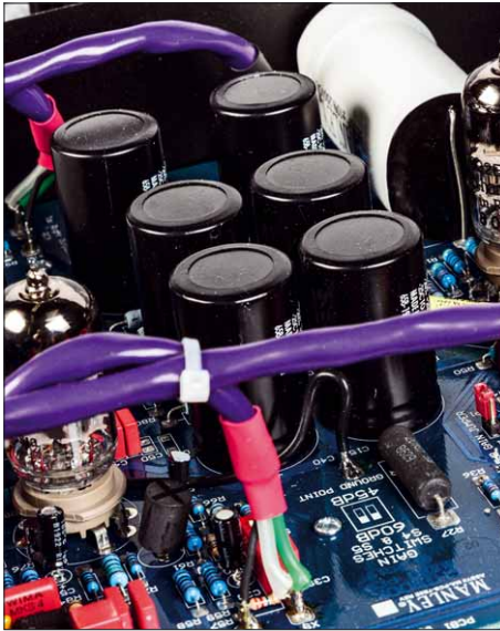
Die Ausgangsstufe arbeitet als sogenannter White-Follower und ist damit sehr niederohmig
