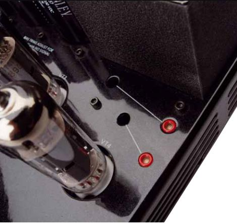
Hier wird der Ruhestrom durch die Endröhren eingestellt
