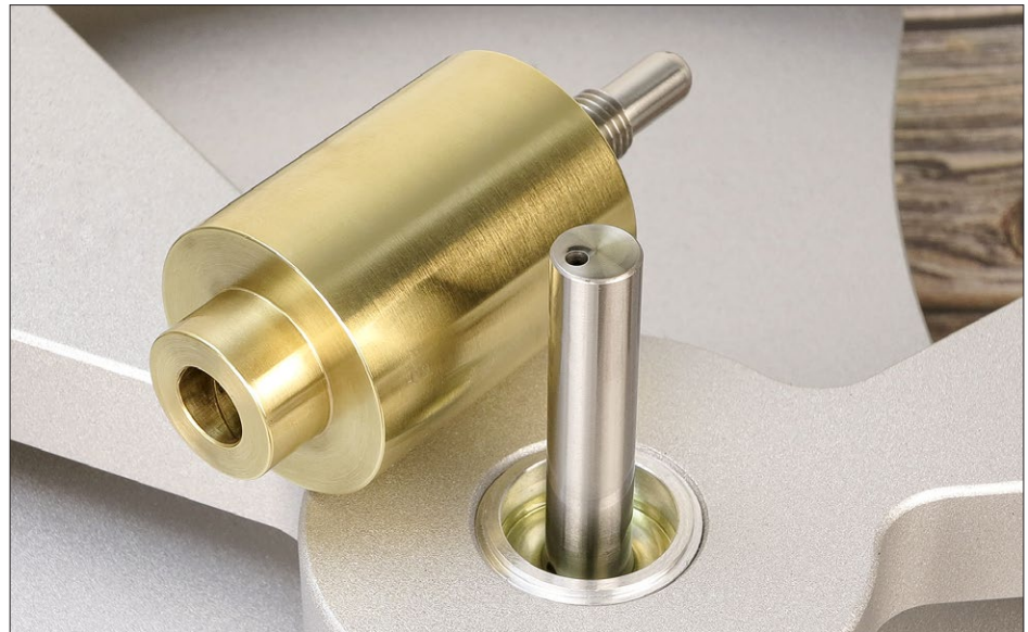
Bevor die Messingglocke drübergestülpt wird, ist das kleine Reservoir am Fuße der Lagerachse aus Edelstahl rund drei Millimeter hoch mit Öl aus einem beige packten Fläschchen zu befüllen.
